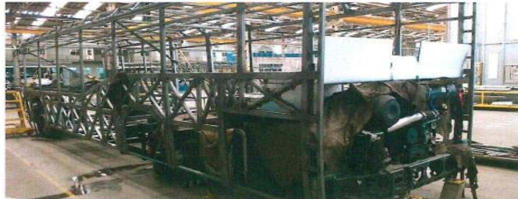
Estructura para chasis y carrocería
