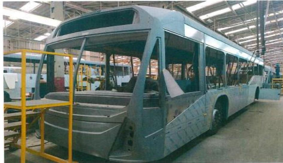
Ensamblado de carrocería
