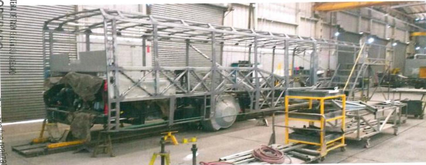
Acondicionamiento de estructura para carrocería
